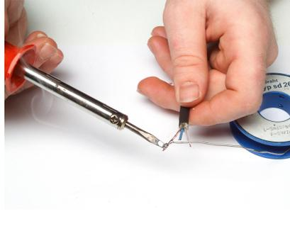
**Bild 5:** Jetzt können Sie die Kabelenden verzinnen. Dazu erhitzen Sie das Lot und halten darüber das Kabelende. Wenn sich dieses erhitzt hat, fließt das Lot von alleine zwischen die Litzen.
