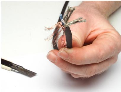
**Bild 3:** Jetzt können Sie das vordere Stück der Isolierung abziehen und sehen das Innenleben des Kabels mit den beiden Leitern, der Abschirmung und den Seilen, die für die Elastizität des Kabel sorgen.
