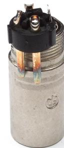
**Bild 8:** Ist das Lot noch konvex im Kontakt, haben Sie nicht genügend Hitze zugeführt. Sie müssen den Lötkebeln einfach noch einmal an die Stelle halten, bis das Lot konvex nach innen läuft. Seien Sie vorsichtig mit der Hitzedosisierung. Zuviel Hitze kann die Stecker beschädigen. Lieber nach dem ersten gescheiterten Versuch den Stecker kurz abkühlen lassen und es nach einige Minuten noch einmal versuchen.
