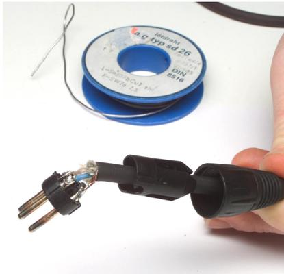
Bild 9: Sind Kabelenden und Steckerkontakte verzinnt, müssen Sie nun die Kabelenden auf die benötigte Länge kürzen und an den Kontakten anlöten. Erhitzen Sie zuerst die Kontakte und führen Sie dann das Kabelende in den Kontakt und halten es so lange fest, bis das Lot erkaltet ist und die Verbindung hält. Schauen Sie vor dem endgültigen Zusammenbau des Steckers, ob sich nirgendwo Lötreste oder andere „Kurzschluss-Materialien“ verstecken.
